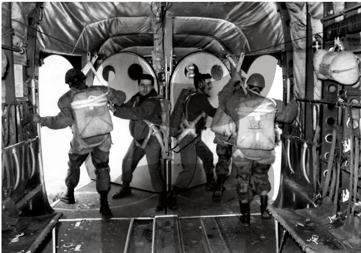
I due direttori di lancio, in contatto fisico e visivo, danno il “via” agli ultimi paracadutisti in uscita dal C-119 della 46ª Aerobrigata a cavallo degli anni Settanta. Subito dopo recupereranno le funi di vincolo.
