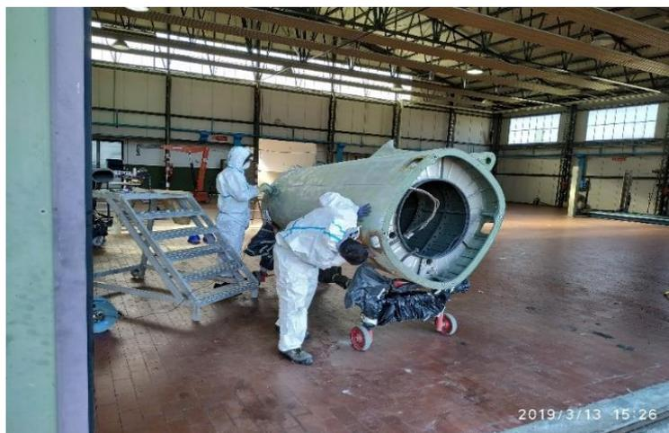
(Nelle foto: le operazioni codificate "codice rosso" per gli studenti, eseguite in officina esterna – le operazioni "codice arancione" – la ricostruzione dell'alloggiamento tubo di pitot, strappato vandalizzando la fusoliera del velivolo).
