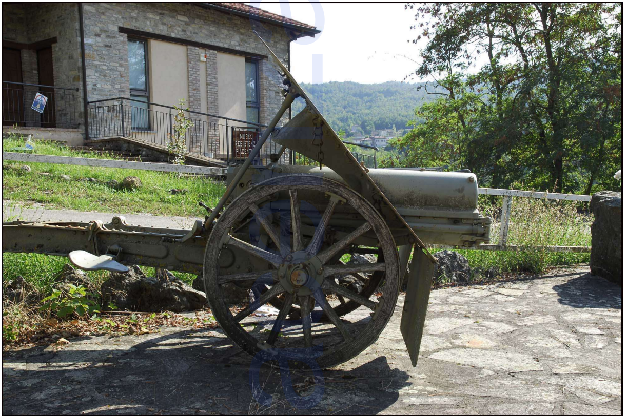
Monumento ai caduti di Sperongia, Morfasso. Obice 75/13 modello 1915, lo stesso tipo usato da Garibaldino.
